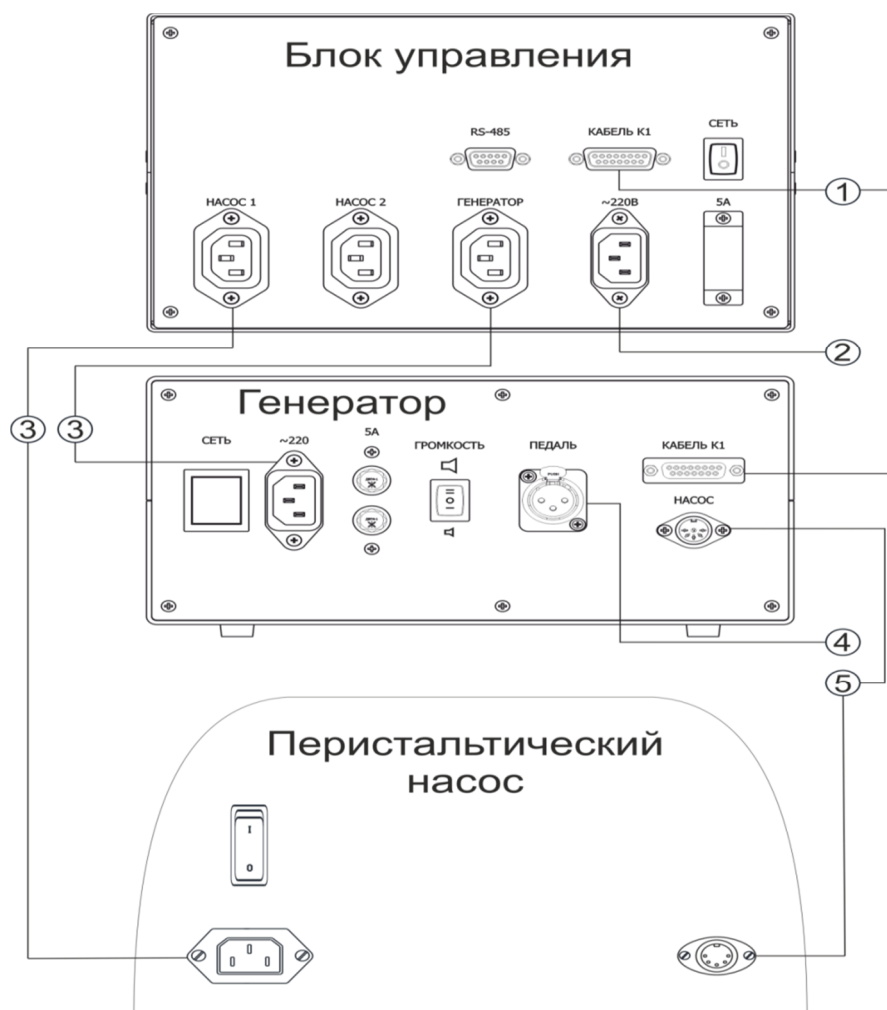
Рисунок 3.9 – Схема подключения функциональных блоков и педали (см. табл. 3.1).
